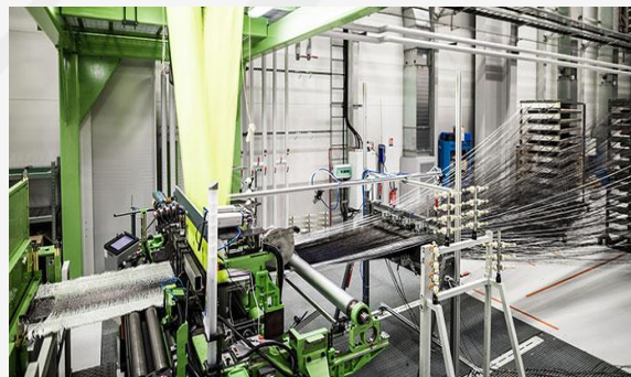
3D-s kompozitokhoz automata Jacquard 2.0 szövőgép
